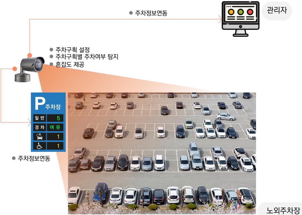
일반적으로 주차정보(유도관제) 시스템은 대형쇼핑몰이나 아파트단지 등 건물내 지하주차장 위주로 초음파센서나 영상센서를 천장에 설치하여 주차면을 감시하는 시스템으로 구성되어 있어 노외주차장에서의 활용에 어려움이 있습니다.
